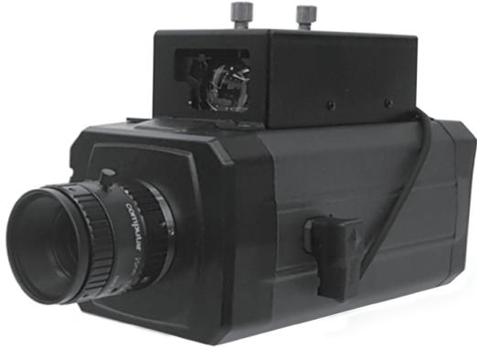
KEC-VAi202L은 영상 기반의 2차원 변위 측정 소프트웨어 프로그램을 내장하고 레이저에 의한 거리 측정 기능을 통합한, 3차원 스마트변위 측정 시스템이다.
